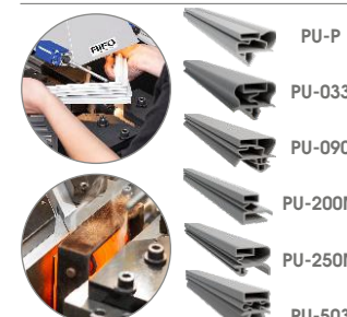
ZGRZEWANIE USZCZELEK GASKETS WELDING
